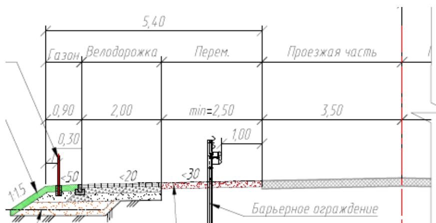
Рисунок 15.5 – Вариант поперечного профиля автодороги 41К-128 с велодорожкой по краю проезжей части
